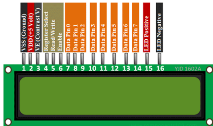
Fig. 2: 16x2 LCD Module Pin out
